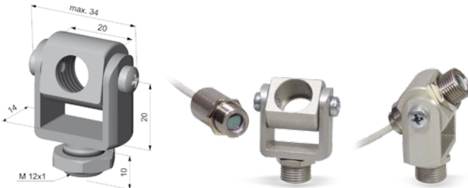
TM-MG-CT Montagegabel mit M12x1-Gewinde, justierbar in 2 Achsen
