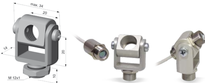
TM-MG-CT Montagegabel mit M12x1-Gewinde, justierbar in 2 Achsen
