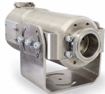
TM-J-CTL Kühlgehäuse (Länge 228 mm, ø 89 mm) mit verstellbarem Montagewinkel TM-JAB-CTL; geeignet für Umgebungstemperaturen bis zu 180 °C
