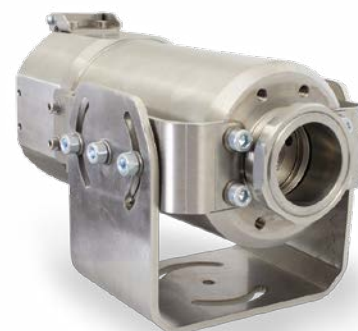
TM-J-CTL Boîtier de refroidissement (longueur 228 mm, ø 89 mm) avec TM-JAB-CTL équerre de montage réglable ; idéal pour les températures ambiantes allant jusqu'à 180 °C
