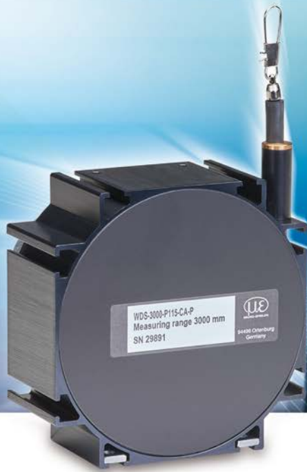
Modell P115 (Messbereich 3000/4000/5000 mm)
